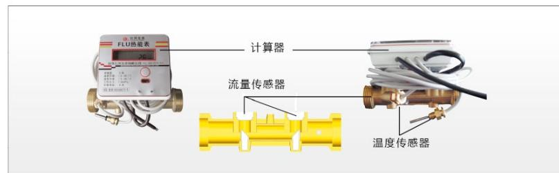
我公司热能表采用反射式时差法进行流量测量。其原理是根据声波在顺流和逆流时的传播速度不相等，通过流量传感器测量在这两种不同的速度下超声波传播存在的时差，经过计算得出流体的流速，然后再换算成流量，再根据配对温度传感器给出的供、回水温度，以及水流经的时间，就可以计算出该系统所释放或吸收的热量。
