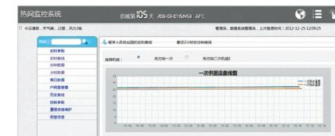
参数实时曲线功能是对运行实时参数的以曲线图的形式来表示，它对当前从热源或热力站采集到的供回温、供回压进行曲线绘制，可以通过系统绘制的曲线图直观的对比供回温、供回压的差别并以此来判断当前阀门的开关度等。可以选择查看一次侧或二次侧的参数实时曲线。
